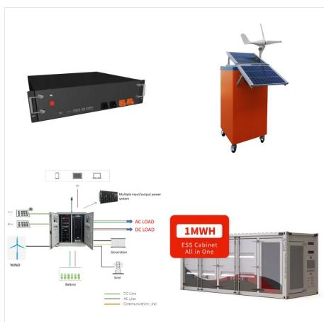
BESS: Battery Energy Storage System. Installation eller anlaeg best?ende af ?n eller flere battericeller til at oplade energi. Oplades ofte af vedvarende energikilder som vindm?ller eller solceller og lagrer energien til den skal benyttes. Kan ogs? daekke over UPS-systemer. CID: Current Interrupt Device.
